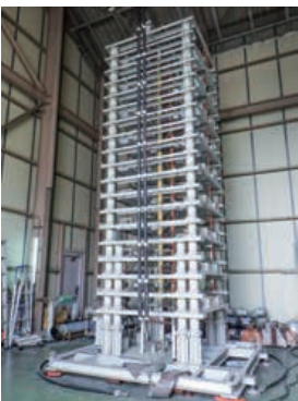
▲技術研究所外観 ◀1,800kV衝撃電圧発生装置
