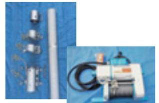
▲鋼管柱組立工具
