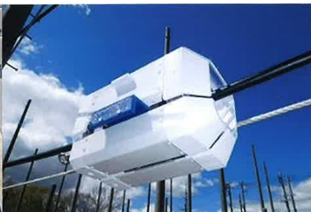
架空延線ロボット
