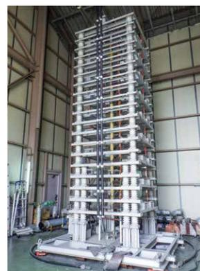
1,800kV衝撃電圧発生装置
