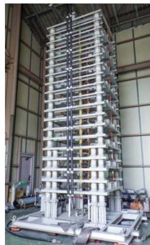
1,800kV衝撃電圧発生装置
